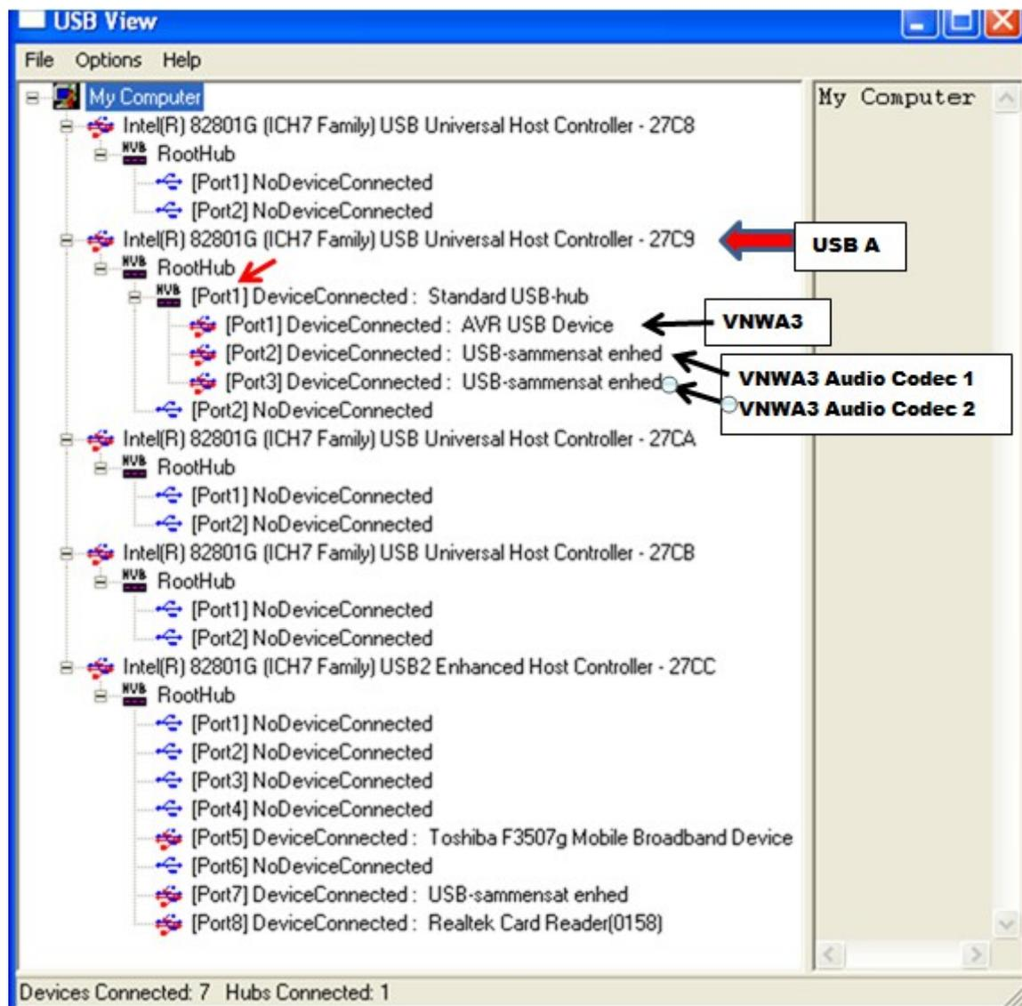
Wie gesagt, der 27C9 USB Universal Host Controller bedient die drei VNWA USB Elemente, das AVR USB Device und die zwei USB-Codex. Wenn Sie eine VNWA2 benutzen oder Ihr VNWA3 ist nicht mit dem Option Bord ausgestattet, dann wird es nur ein Audio Codec, als verbunden, angegeben.
