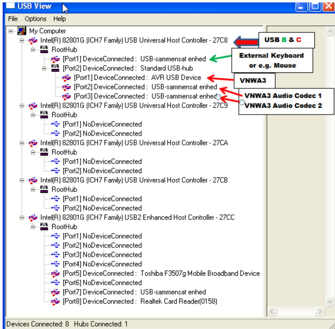
Allerdings kann diese Situation gelöst werden, wenn die USB-Tastatur über einen externen USB-Hub an USB B angeschlossen wird. Siehe unten...
