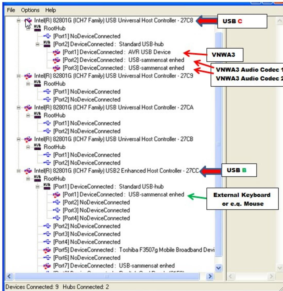
Wie ersichtlich wird der USB-B bedient durch den 27CC USB2 Enhanced Host Controller und teilt sich nicht länger einen gemeinsamen RootHub mit dem VNWA3 und die Signalgenerator Modulation ist sauber wie ein "Pfeifenton".
