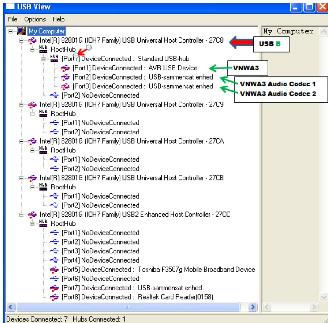
Ebenso bedient der 27C8 USB Universal Host Controller nun die drei VNWA USB Elemente, das AVR USB Device und die zwei USB-Codexs. Wenn Sie einen VNWA2 haben oder Ihr VNWA3 ist nicht mit dem Option Bord ausgestattet ist, dann wird nur ein Audio Codec als verbunden angegeben werden.
