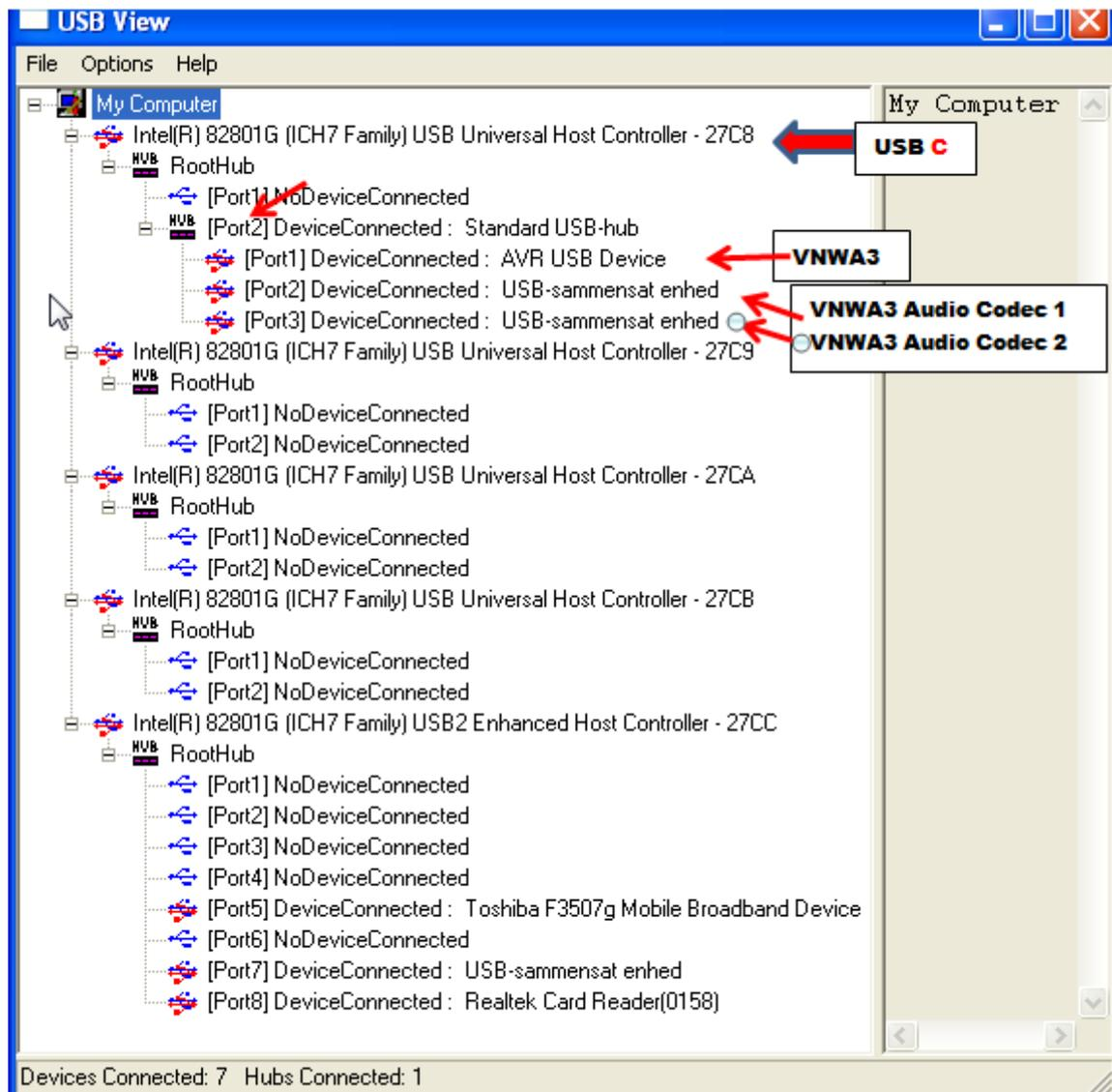
Ebenso bedient der 27C8 USB Universal Host Controller nun die drei VNWA USB Elemente nun über Port2, das AVR USB Device und den beiden USB-Codecs. Wenn Sie einen VNWA2 haben oder Ihr VNWA3 ist nicht mit dem Option Bord ausgestattet ist, dann wird nur ein Audio Codec als verbunden angegeben werden.
