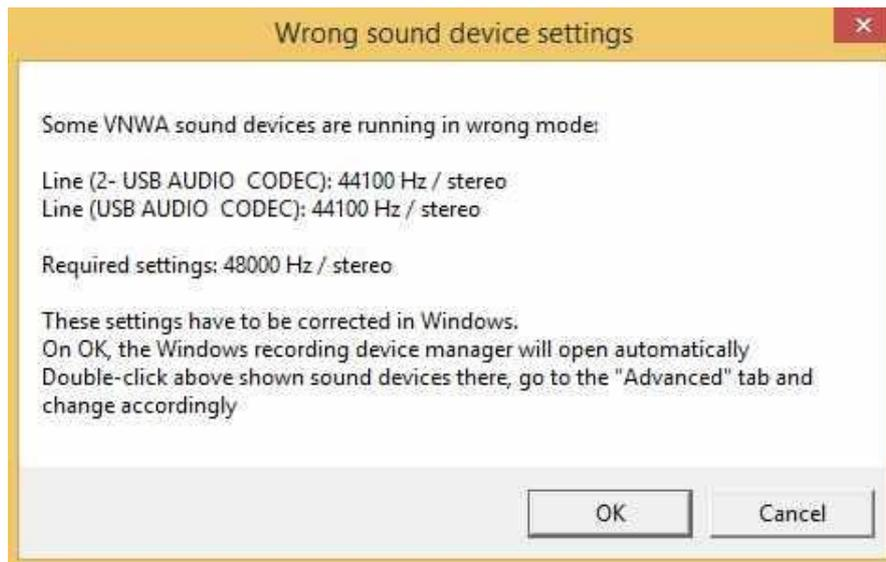
3.4.10 Um die Konfiguration des Sound Device zu korrigieren, klicken Sie auf den USB-Audio-Codec und die Eigenschaften werden angezeigt. Wähle aus **Advanced** Tab und setze sample und bit rate auf **2 channel 16 bit 48000 Hz (DVD Quality)**. Drücke **“Apply”** und **“Ok”**.
